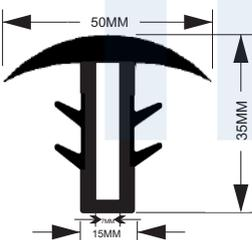
Indicado para vedações de placas solares com vão de encaixe de 15 a 20mm, aba de vedação de 50mm.
