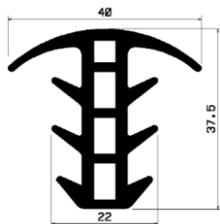
Indicado para vedações de placas solares com vão de encaixe de 17 a 22mm, aba de vedação de 40mm.
