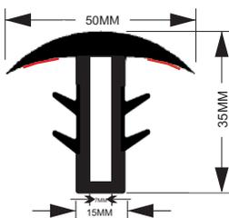
Indicado para vedações de placas solares com vão de encaixe de 15 a 20mm, aba de vedação de 50mm com adesivo de alta performance para auxiliar na aplicação e estanqueidade.
