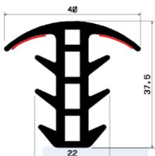
Indicado para vedações de placas solares com vão de encaixe de 17 a 22mm, aba de vedação de 40mm com adesivo de alta performance para auxiliar na aplicação e estanqueidade.
